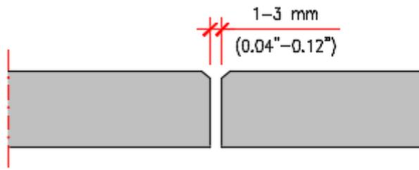
Figure 3.15 - Bevelled edge
