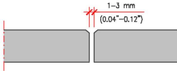
Figure 2.26 - Bevelled edge
